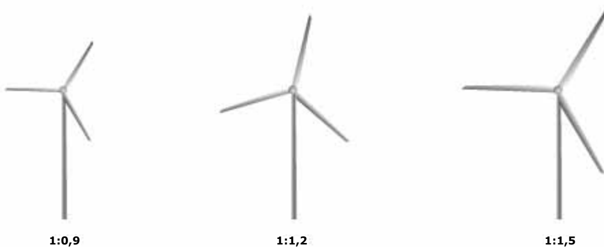
Figur 2. Harmoniforhold. Forholdet mellem vindmøllernes tårnhøjde og vingefang er afgørende for, hvordan møllerne opfattes i landskabet. Moderne, høje vindmøller på op til 150 meter totalhøjde har mere rolige bevægelser og en mere slank karakter end ældre modeller, og kan bære længere "arme".
